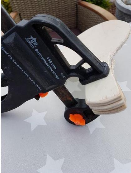
Damit der Leim/Kleber gut trocknet, spannt man den Schlägergriff in eine Schraubzwinde, und lässt ihn eine Stunde trocknen.
