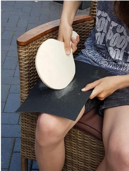
Nun geht es ans Schleifen. Die Ränder aller Holzteile müssen gut abgeschliffen werden.
